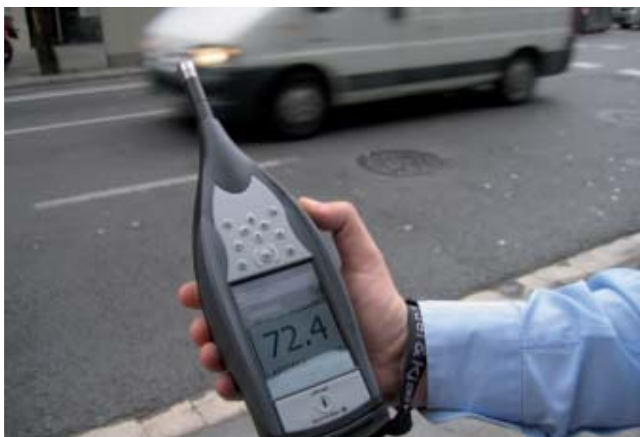
El nou sonòmetre, que té un disseny ergonòmic, permet prendre mesures acústiques en terços d'octava
